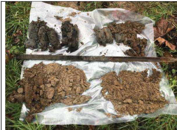
Boring 3; uitgelegd van rechtsonder naar linksboven. In de guts is de venige restgeulvulling duidelijk te herkennen. Boven de guts ligt hetzelfde traject als in de guts zit, maar geboord met edelmanboor (om het beddingzand op te boren).
