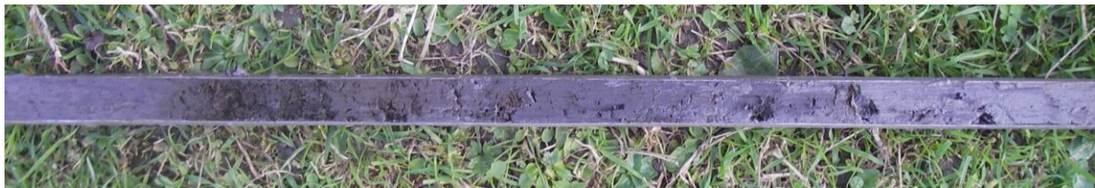
Figuur 14: Foto van boring 5 met links de zwak humeuze, matig stevige klei die onder de bouwvoor is aangetroffen, in het midden de laag sterk venige klei met daaronder (rechts) de zwak venige klei.
