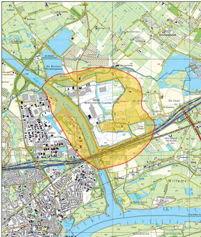
figuur 5.1 Geluidzone industrie van bedrijventerrein Medel conform de parapluherziening zonering industrielawaai bedrijventerrein Medel 2014 (bron: Rho Adviseurs, 2014)
