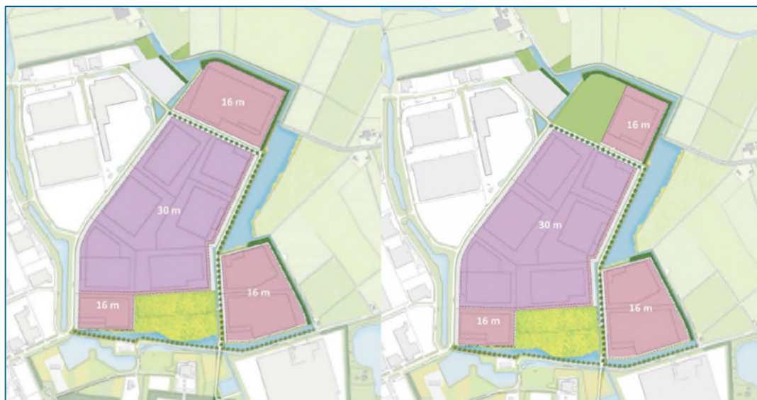
Figuur 2.3: Maximale bouwhoogten met links de oude situatie en rechts de nieuwe situatie (ongewijzigd)
