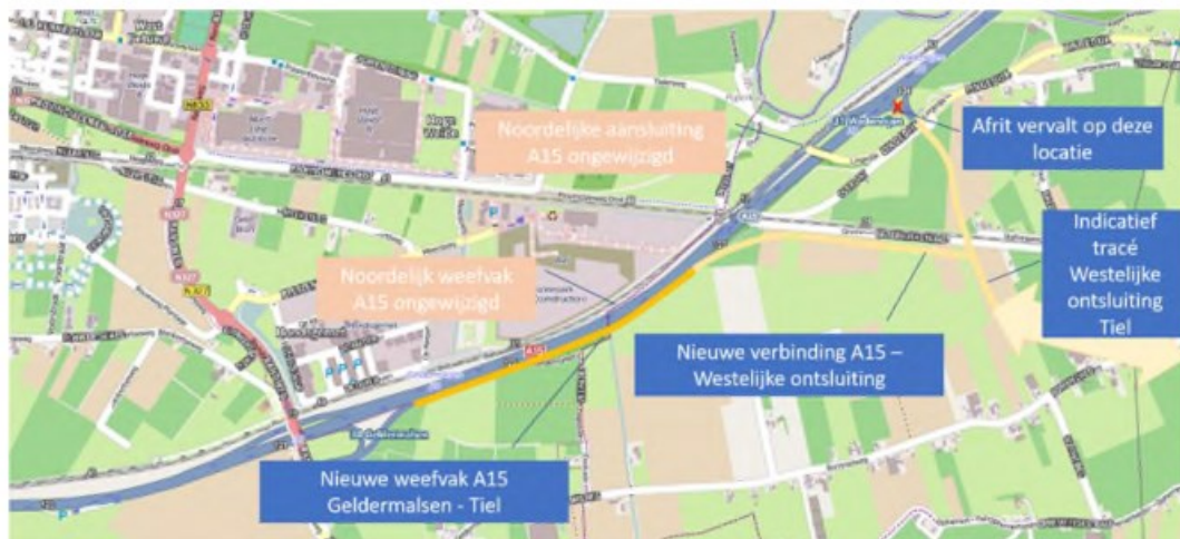
Figuur 3.10 Variant A extra weefvak zuidelijke rijbaan A15
